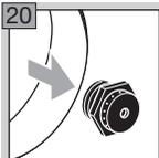
▷ Ионизационный электрод и электрод розжига можно снять, не снимая камеру сгорания.
