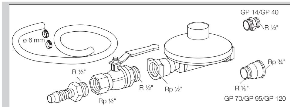
Редукционный клапан, шаровой кран, шланг (длина = 2 м), 2 хомута для шланга, двойной ниппель R 1/2" для GP 14/GP 40, переходник R 1/2" – Rp 3/4" для GP 70 – GP 120, для подключения компактного блока газовых клапанов CG к газу, артикул: N52600025
