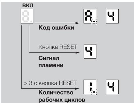
Код ошибки: ошибка немедленно отображается в виде буквы и цифры, сменяющих друга друга на дисплее, и сигнализирует о предупреждении или неисправности, см. стр. 11 (Помощь при неисправностях). Сигнал пламени: при нажатии кнопки сброса RESET отображается сигнал пламени, см. стр. 9 (Сигнал пламени).
