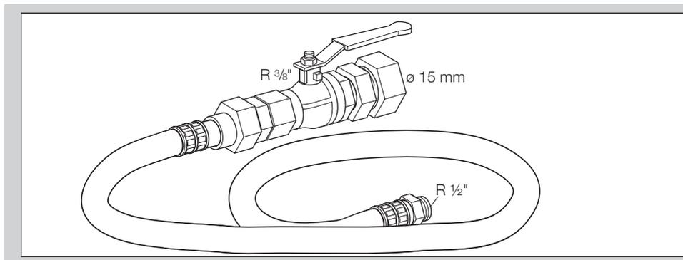
Шаровой кран и шланг (сертифицирован по DVGW, длина = 2 м) для подключения компактного блока газовых клапанов CG к газу, артикул: N52990209
