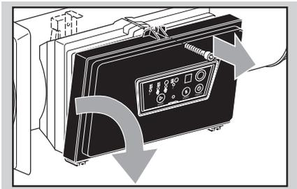
▷ Для этого вращайте винт с крестообразным шлицем несколько раз против часовой стрелки до тех пор, пока его можно будет приподнять.
