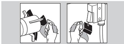
**15** Проверьте исправность флюгерного выключателя.
